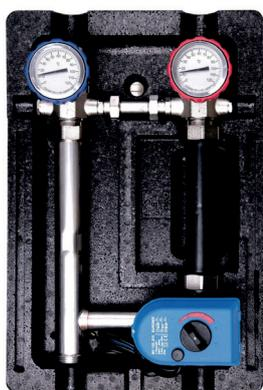
Применяется для плавного регулирования температуры подающей линии за счёт подмеса теплоносителя из обратки. Для автоматического регулирования устанавливается трёхпозиционный сервопривод (арт. 270013).
