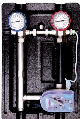
Применяется для одного смесительного контура с функцией поддержания постоянной температуры подающей линии (0 - 100°C электронное управление). Присоединяется к коллектору НКV 160 мм.
