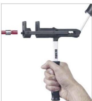
6. Mettez l'outil dans la position de départ et retirez le tube expansé. (Ouvrir le levier mobile complètement).
