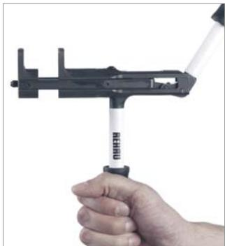
2. Werkzeug in Ausgangsposition bringen. Hierzu beweglichen Hebel vollständig öffnen (> 150 °).
