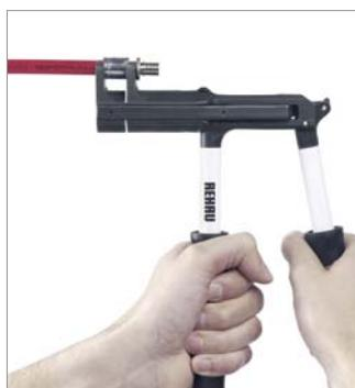
9. Hebel zügig, nicht ruckartig, zusammendrücken und Schiebehülse bis zum Fittingkragen verpressen.
