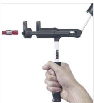
6. Riportare l'attrezzo nella posizione di partenza prelevando il tubo allargato. (Aprire l'azionatore mobile completamente)
