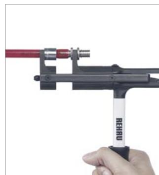
8. Werkzeug an der Verbindung vollständig ansetzen.
