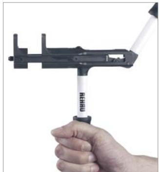
2. Riportare l'attrezzo nella posizione di partenza. Aprire l'azionatore completamente ( $\geq 50^\circ$ ).
