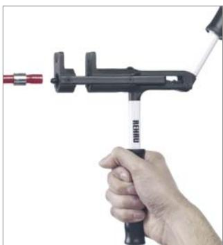
6. Werkzeug in Ausgangsposition bringen und aufgeweitetes Rohr entnehmen. (Beweglichen Hebel vollständig öffnen)
