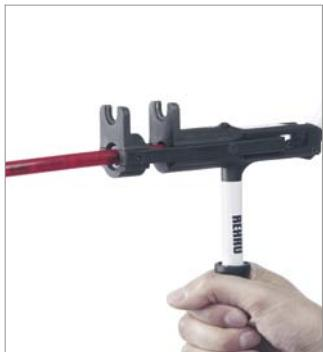
4. Rohr durch die Schiebehülse bis zum Anschlag in das Werkzeug einschieben.
