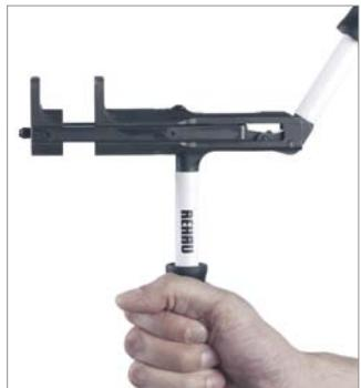
2. Riportare l'attrezzo nella posizione di partenza. Aprire l'azionatore completamente ( $\geq 50^\circ$ ).
