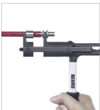
8. Werkzeug an der Verbindung vollständig ansetzen.
