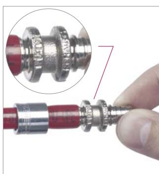
7. Enfilez le raccord sur le tube jusqu'à la butée. Après rétraction (effet mémoire), le raccord est solidement fixé sur le tube.
