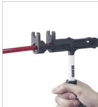
4. Glissez la bague à sertir sur le tube jusqu'à la butée.
